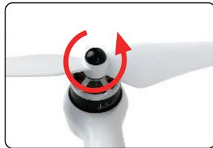
3.2 Ziehen Sie Propeller mit den passenden Markierungen von Hand an. Werkzeug wird nicht benötigt.
