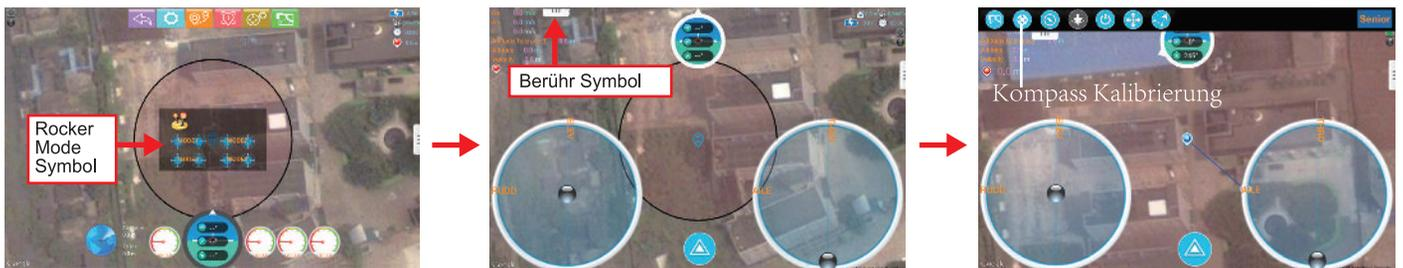
**Wichtig** Stellen Sie sicher das die Motoren vor der Kalibrierung verriegelt sind (Die rote LED des Quadrocopters blinkt nicht).
