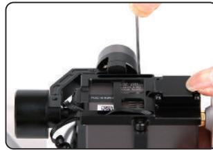
9.3 Installieren Sie die Kamera im Gimbal mit den beiden M2x4 Schrauben so dass die Kamerallinse frei bleibt.
