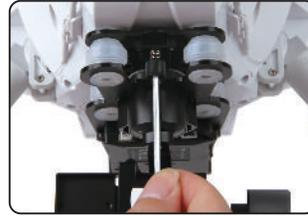
8.3 Installieren Sie die M3x12mm Federschraube um den Gimbal zu sichern.
