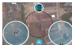
Drücken Sie lange das Stabile Modus Symbol um die Motoren zu entsperren
