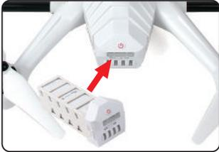
4.1.1 Installieren Sie den vollgeladenen Akku, schalten diesen aber nicht ! an. Bitte schauen Sie in die Hinweise zum Ladegerät, wie der Akku geladen wird.
