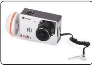
9.1 Schrauben Sie die weiße Pilzantenne in die Kamera und sichern diese vorsichtig mit dem beiliegenden Werkzeugschlüssel.
