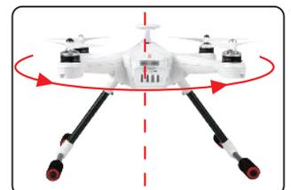
7.4 Horizontale Rotation. Rotieren Sie um die Dreh Achse in 90° Grad Schritten und verharren alle 90° Grad 1 Sekunde lang in der jeweiligen Position.
