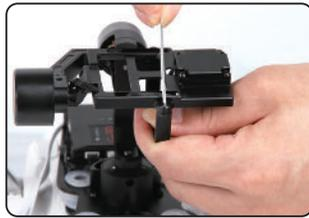
9.2 Entfernen Sie die beiden M2x4 screws welche die Kamerahalterung sichern.
