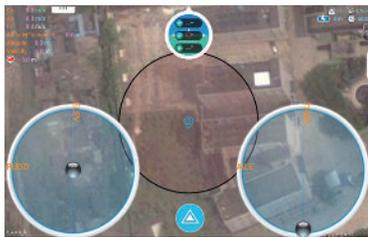
Berühren Sie im Hauptbildschirm das Symbol um in die Knüppelkontrolle und Einstellungen zu gelangen. Drücken Sie lange das Stabile Modus Symbol um die Motoren zu entsperren.
