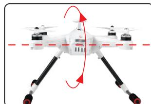
7.2 Vorwärts-Rotation. Rotieren Sie den Quadrocopter in 90° Grad Schritten und verharren alle 90° Grad 1 Sekunde lang in der jeweiligen Position.
